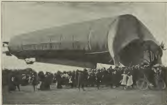
Avería sufrida por el globo dirigible alemán Zeppelin II al descender á tierra cerca de Goepingen (Wurtemberg) después de haber recorrido en el aire 1.200 kilómetros en 37 horas. (De fotografía de Frankl.)
